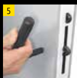
leichte und schnelle Montage durch Nut- und Feder-System mit Exzenter-Spannschlössern, 80/100 mm Wandpaneele im Rastermaß von 300 mm, bzw. Paneelbreiten von 300, 600, 900 und 1200 mm
