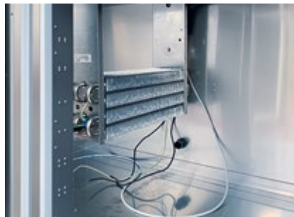
Verdampfer aus Edelstahl (Produktionsansicht)
