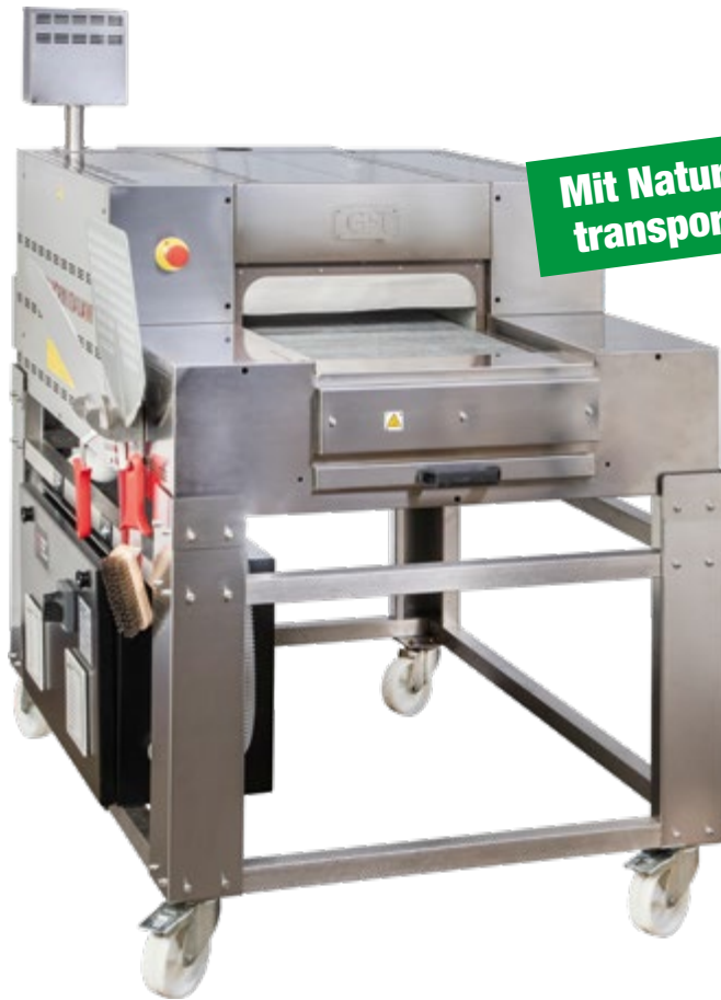
Tunnelofen Stone mit Natursteintransportband
