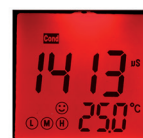
Im Alarmzustand / Alarm condition
