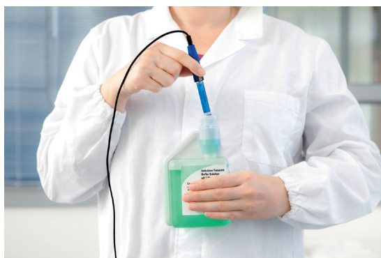
Elektrode kalibrieren Calibrate electrode
